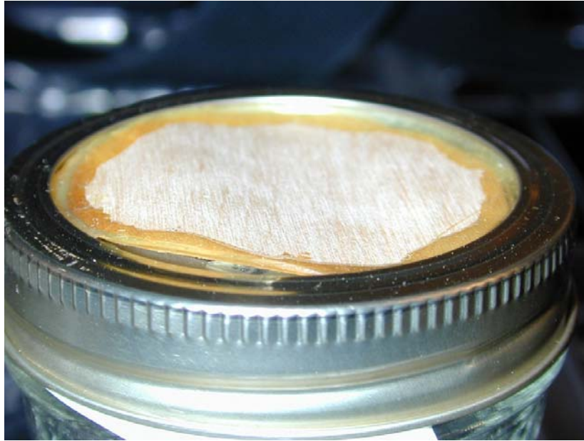
Figure 11: Exemple de cellule de diffusion rejetée suite à un bris du joint d'époxy.
