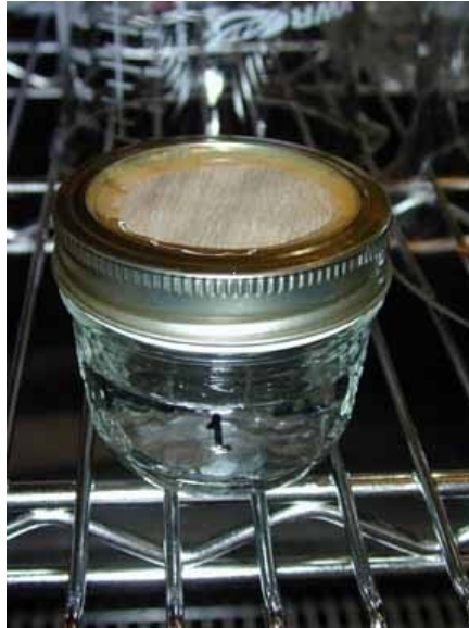
Figure 10: Cellule de diffusion utilisée lors de la détermination du taux de transfert de vapeur d'eau en régime permanent.
