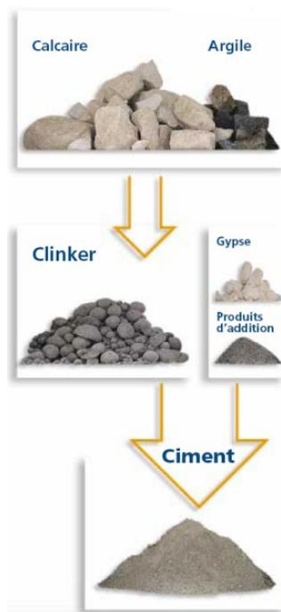
Figure 2-1 : Représentation schématique du procédé de fabrication des ciments
