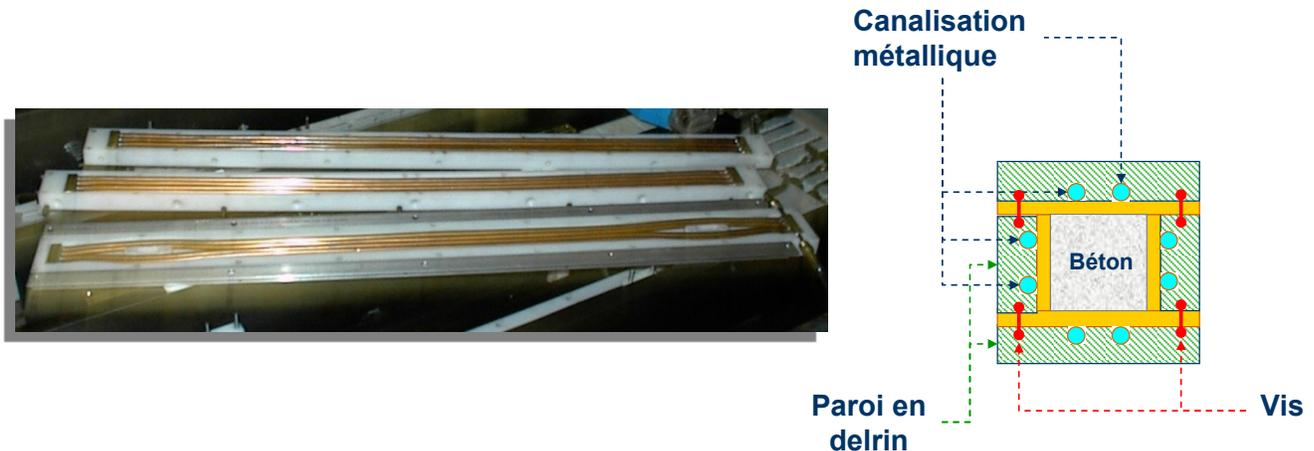
Figure 4-8 : Nouvelle conception des canalisations dans des parois du montage R<sup>2</sup>D<sup>2</sup>
