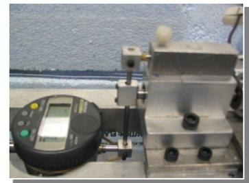
Figure 4-23 : Dispositif de calibration du capteur de proximité inductif.
