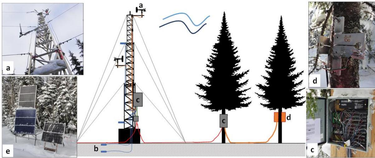
**Figure 0.3:** Dispositif expérimental. Avec a) anémomètres, b) sondes de températures, c) acquiseurs de données, d) jauge de contraintes, et e) panneaux solaires
