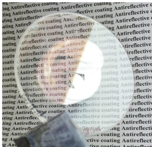
Figure 2-3: Substrat circulaire de PMMA avec une nanostructure antireflet. Le côté gauche du substrat contient la NS, le côté de droite est le PMMA sans antireflet.
