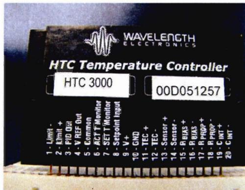
Figure 3.13 Contrôleur de température HTC-3000, de Wavelength Electronics
