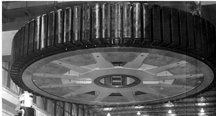
Figure 82: Photo du rotor du générateur MH95
