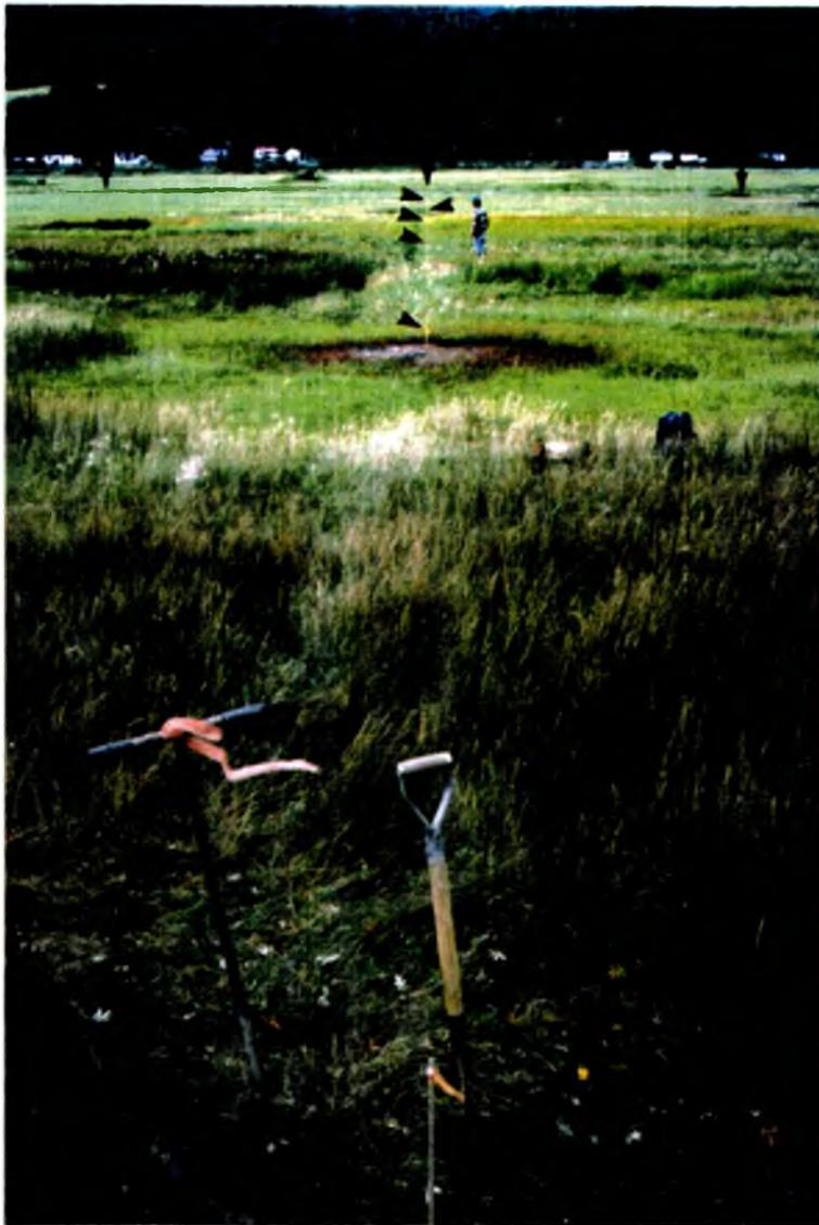
Fig. 6 Transect topographique effectué sur le schorre supérieur du ruisseau aux Vases à l'aide du niveau de précision GDD. Le profil est orienté E85°O en direction du marigot. Les flèches indiquent la position des tiges sur le marais et l'emplacement du ruisseau. (3 septembre 1988)
