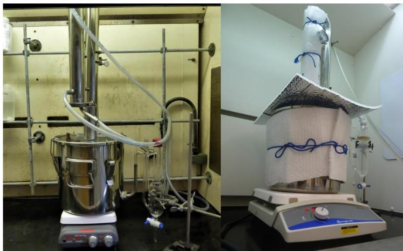
Figure 20. Alambic portatif conçu dans le cadre de ce projet d'investigation d'huiles essentielles.
